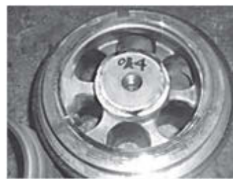
写真2 取り外した吸入弁(シート面欠損)
