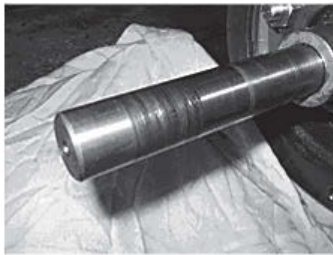
写真1 焼付き試験終了後のシャフト部写真
